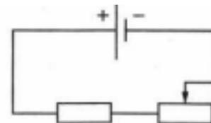
№5. На рисунке изображена электрическая цепь, состоящая из источника тока, резистора и реостата. Как меняется при передвижении ползунка реостата вправо его сопротивление, сила тока в цепи и сопротивление резистора? Для каждой физической величины определите соответствующий характер изменения. К каждой позиции первого столбца подберите соответствующую позицию второго и запишите в таблицу выбранные цифры под соответствующими буквами. Цифры в ответе могут повторяться.
